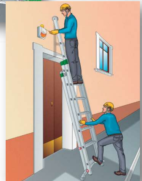
scala trasformabile a tre tronchi in configurazione di appoggio
