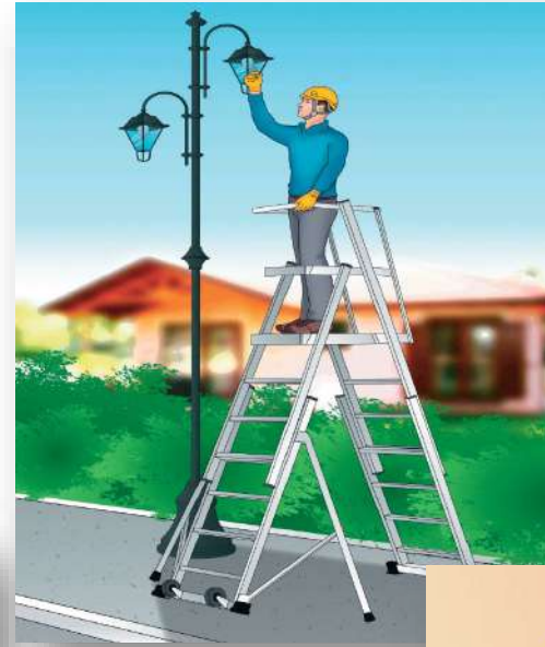
scala mobile con piattaforma
