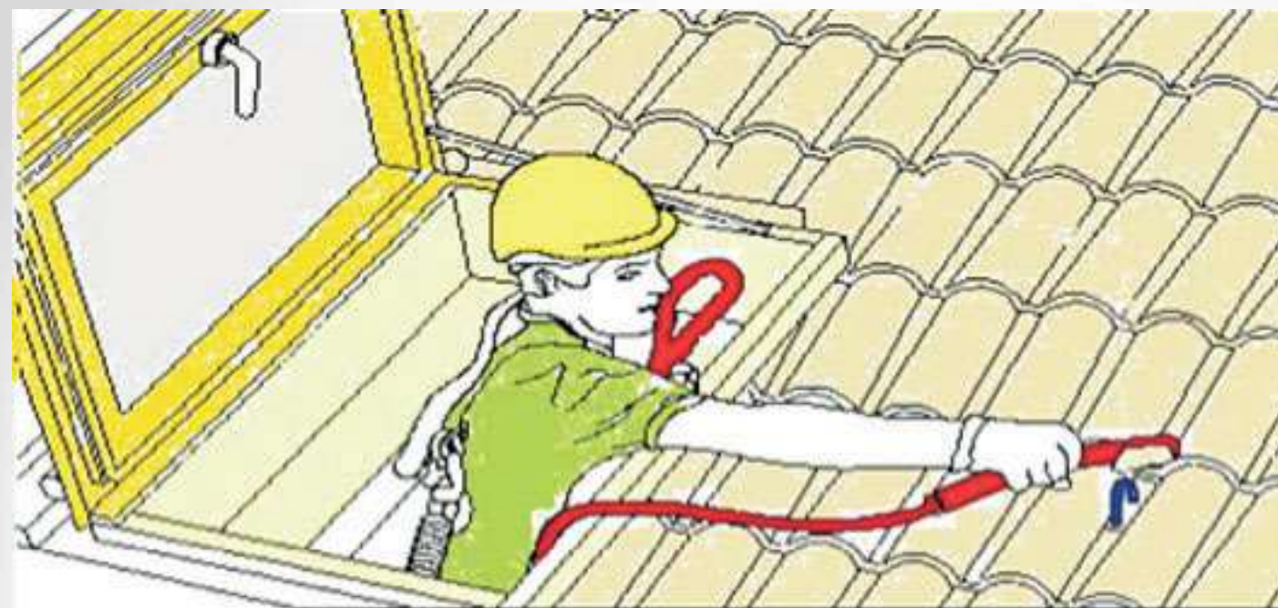
Esempio di ancoraggio puntuale di accesso
